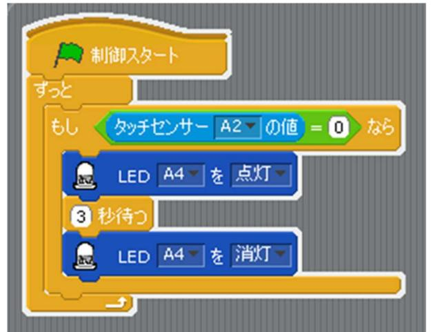
1 LED白 (A4)、タッチセンサを2つ用意し (A2, A3)、タッチセンサのどちらかを押せばLED白が3秒点灯する。
